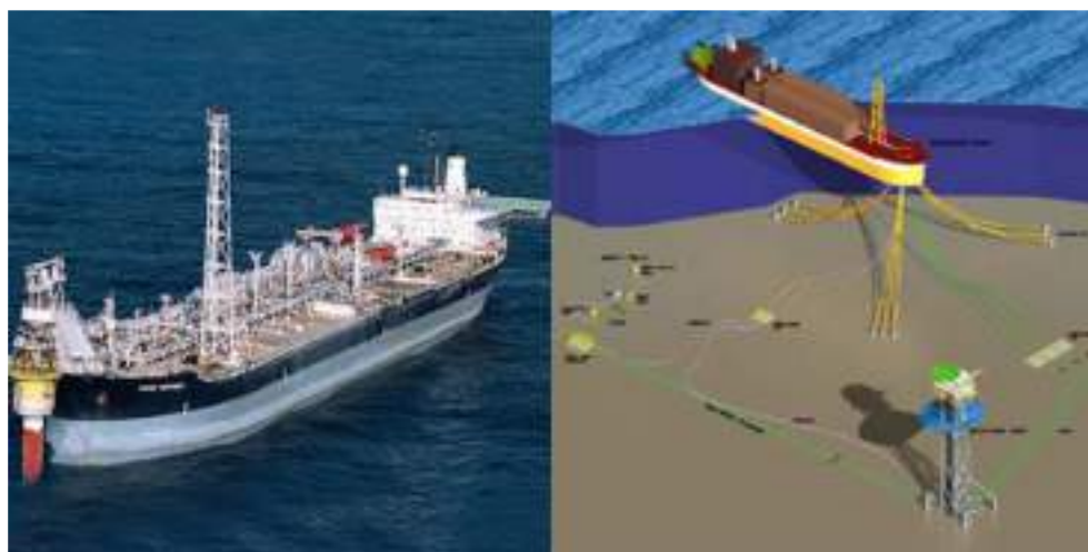
Slika 1.13 Plutajući brodovi za eksploataciju, skladištenje i otpremu ugljikovodika (izvor: https://www.rigzone.com )
