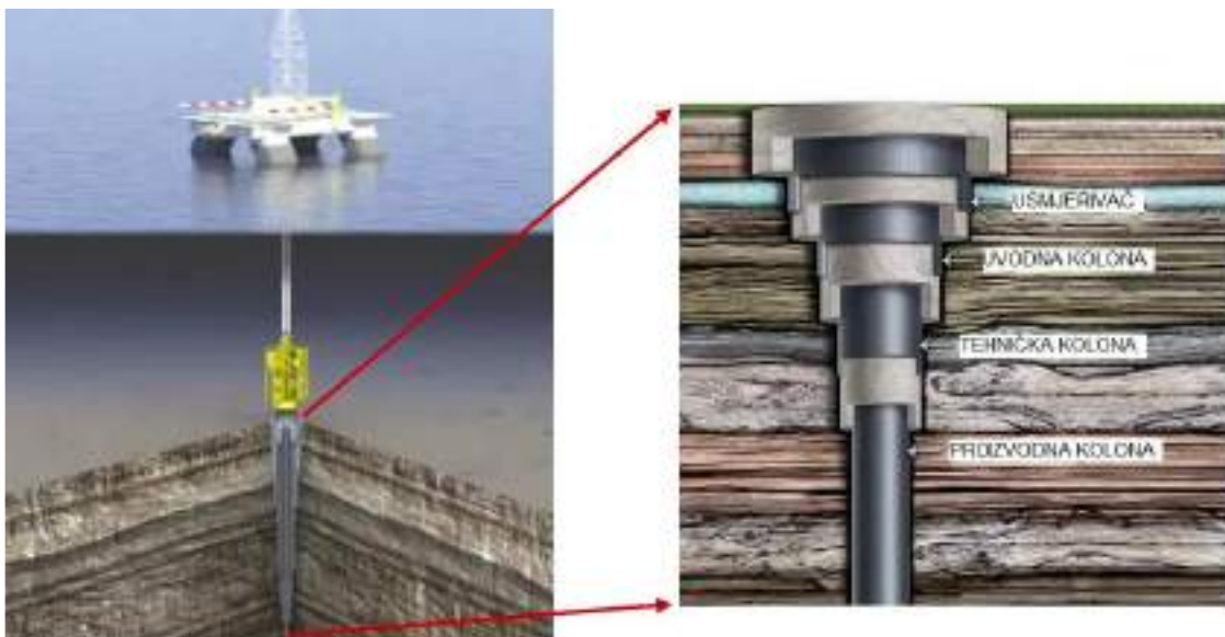
Slika 1.22 Shematski prikaz konstrukcije bušotine
