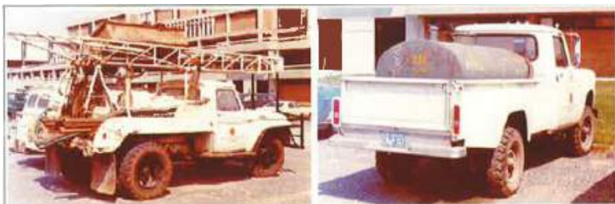
Slika 1.4 Oprema za izradu seizmičkih bušotina; bušača garnitura (lijevo) i cisterna za isplaku (desno) (izvor: Prskalo, 2005.)
