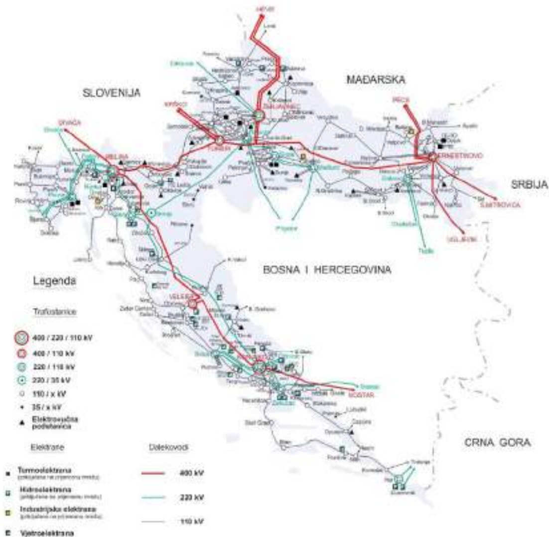
Slika 3.79 Shema Hrvatskog prijenosnog sustava (izvor: HOPS, 2013)
