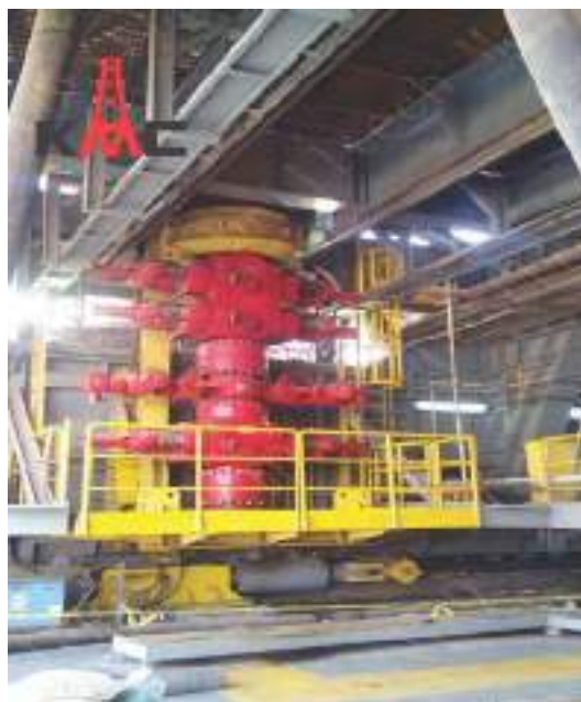
Slika 1.20 Preventerski sklop – BOP (izvor: http://www.drilltech.cn/ufile/201465103760572.jpg )
