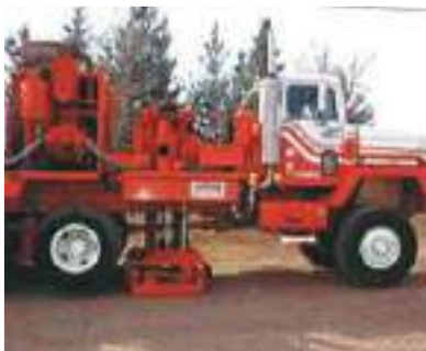
Slika 1.7 Zračni top za rad na kopnu (izvor: Prskalo, 2005.)
