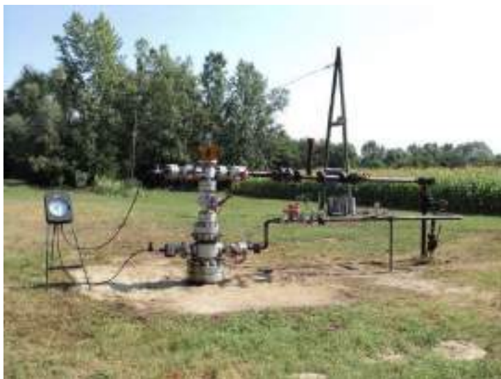
Slika 1.24 Primjer naftne bušotine s plinskim podizanjem
