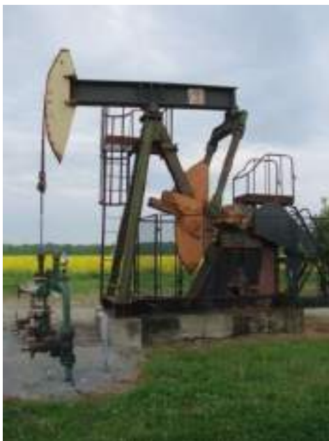
Slika 1.23 Primjer naftne bušotine s dubinskom sisaljkom
